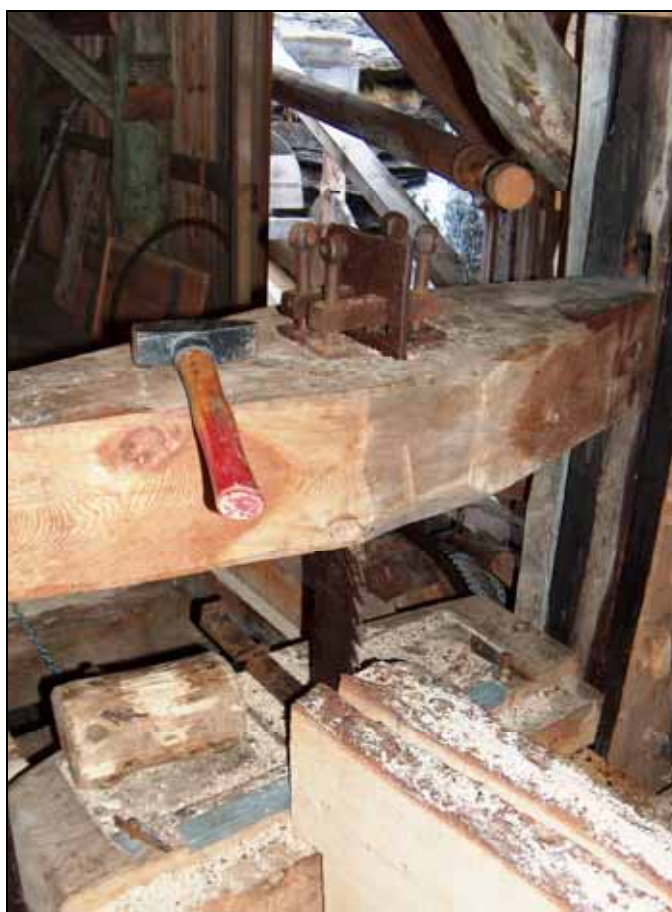
Bildene er fra ei gammel oppgangssag fra Tørvikbygd i Hordaland Til venstre vassrenna med vasshjulet og til høgre sagbenken med sagbladet som går opp og ned
