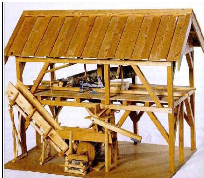
Modell av oppgangssag på Gjølga. Modellen er laget av August Slette. Fra "Fosens historie" s. 386
