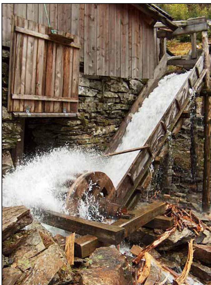
Bildene er fra ei gammel oppgangssag fra Tørvikbygd i Hordaland Til venstre vassrenna med vasshjulet og til høgre sagbenken med sagbladet som går opp og ned
